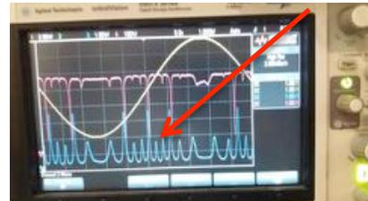
2.4. Adquirir os dados do osciloscópio (.csv) com um pen drive e realizar (em casa, talvez) a análise com base na expressão  $\frac{I_t}{I_0} = \frac{1}{1 + \mathcal{F} \sin^2(\frac{2\pi}{\Delta\nu} A \cos(2\pi\nu t + \phi') + \phi)}$ , sendo  $\frac{I_t}{I_0}$  a fração transmitida da
