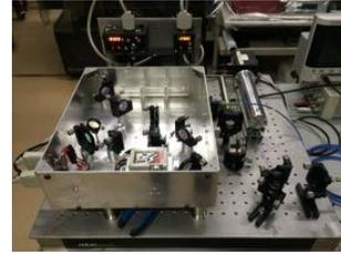
2.2. Observar atentamente o perfil transversal (ou modo transversal) do laser **antes e depois da fibra ótica single-mode**. Para melhor visualização, pode-se colocar um pedaço de papel como nas imagens abaixo. Acompanhar a trajetória do laser saindo da fibra até o fotodiodo, passando pelo Fabry-Pérot, tanto numa frequência de modulação de 100 Hz quanto de mHz (para ver visualmente os modos).
