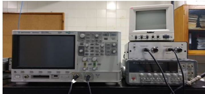
Osciloscópio, gerador de funções e controle corrente e temperatura do laser
