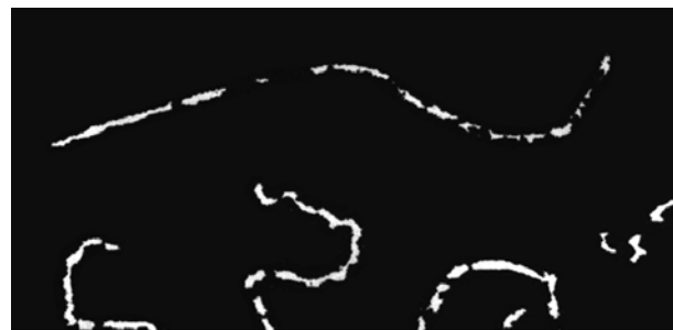
Abb. 2: Nebelkammerspuren von Alpha-Teilchen (oben), Protonen (Mitte) und Elektronen (unten).
