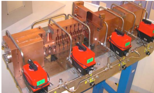
3 GHz linac (62-74 MeV) [C. De Martinis et al, NIM A 681 (2012)]
