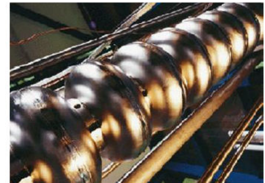
TESLA supraleitender Resonator mit 9 Zellen
