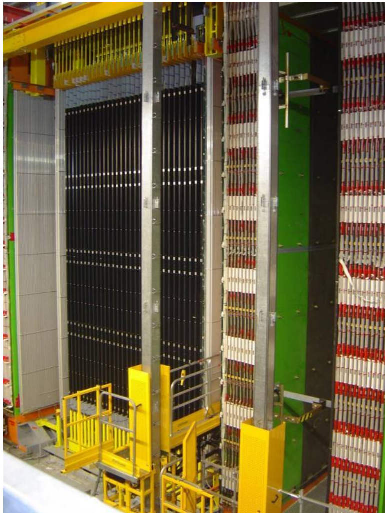
Scintillator planes 5900 m 2 8064 7m long drift tubes
