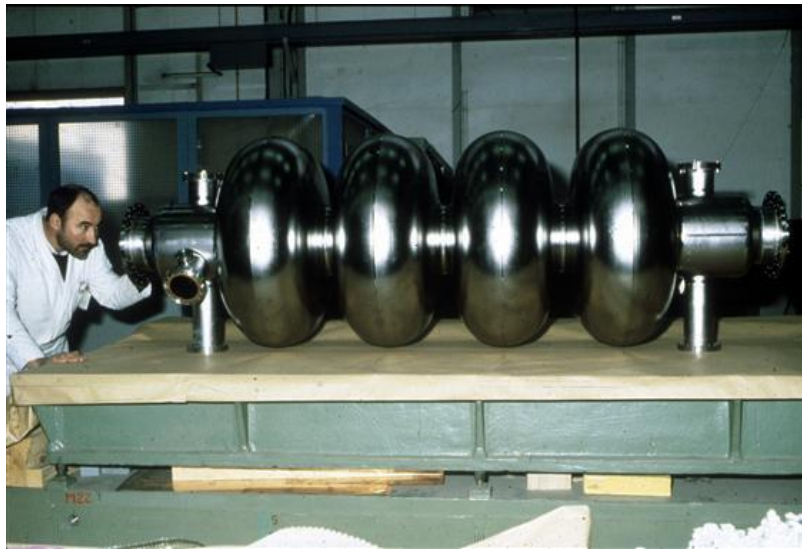
LHC, надпровідні резонаторні структури, 400 МГц, Прискорення 5 МВ /м
