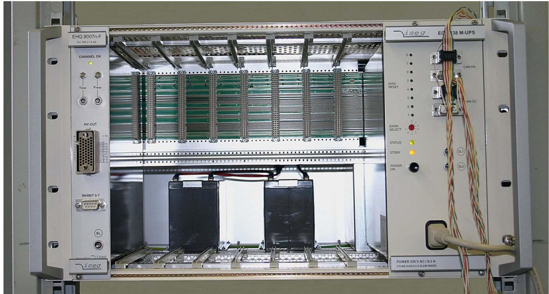
„The Hardware of the ATLAS Pixel Detector Control System“
