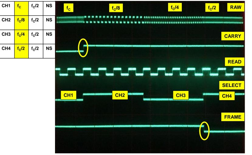
CIRCULATING ORDER: CH1,CH2,CH3,CH4 CARRY PULSE AT THE END OF CH1 IF f<sub>c</sub> APPLIED FRAME PULSE AT THE BEGINNING OF CH4
