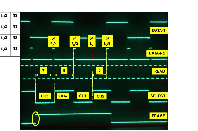
KEY FEATURES: CIRCULATING ORDER CH1,CH2,CH3,CH4 FRAME PULSE AT THE BEGINNING OF CH3
