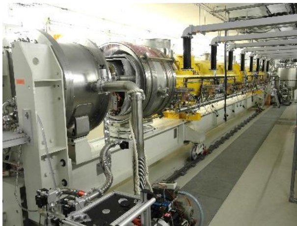
Cryomodule test stand – module inside
