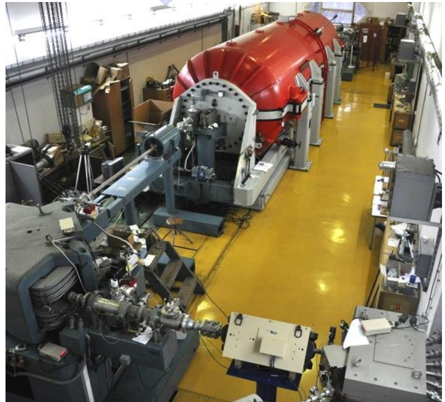
6.0 MV EN Tandem Van de Graaff accelerator
