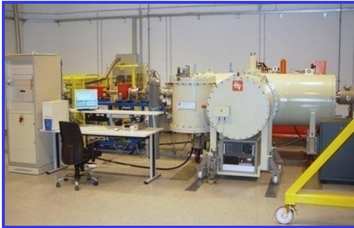
1.0 MV HVE Tandatron accelerator
