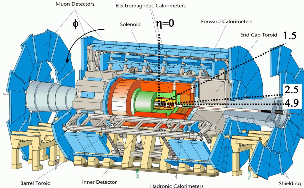
$L \sim 44 \text{ m}, \varnothing \sim 22 \text{ m}$
