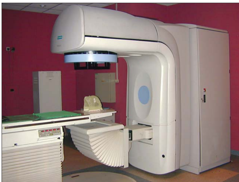
1. ábra. Korszerű lineáris gyorsító 6 és 18 MV foton, ill. 6-21 MeV energiájú elektron-sugarak előállításához.
