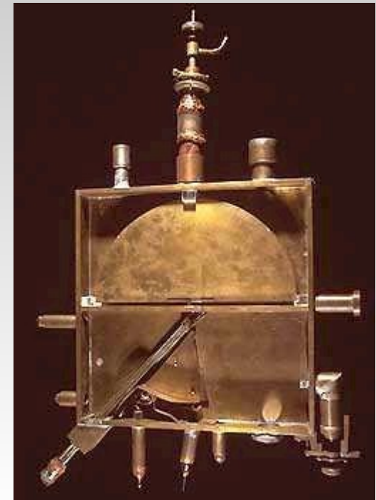
Първият работещ модел на циклотрон (1930г.), създаден от Лоуренс (Ernest Lawrence) E_{\max} = 1\text{MeV}
