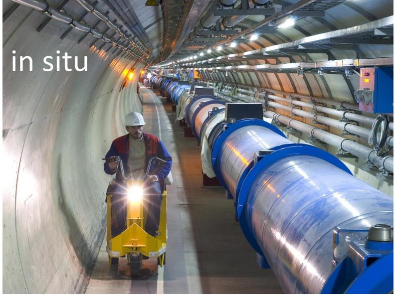
Un nouveau type d'aimant supraconducteur "deux-en-un", fonctionnant à la température de l'hélium superfluide (1.8 degré K). Il en faut ~1250.
