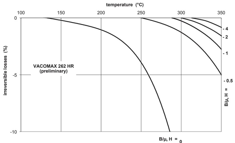
Typische irreversible Verluste für verschiedene Arbeitspunkte in Abhängigkeit von der Temperatur
