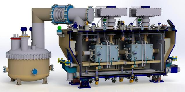
SPS DQW cryomodule + service module
