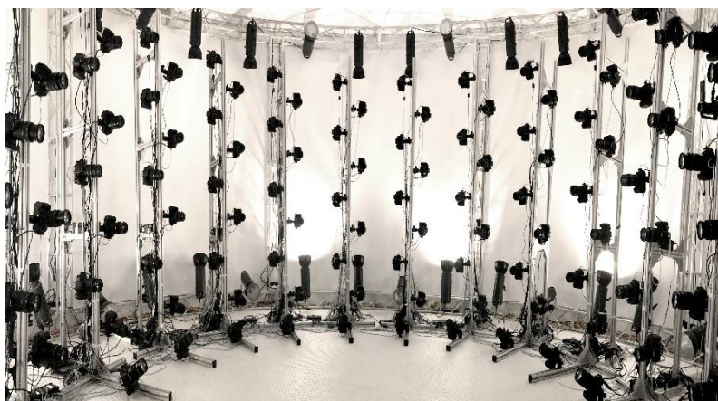
面部/身体 捕捉系统 – 144相机 Facial / Body Capture – 144 Cams
