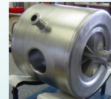
Cavités spoke (CNRS Orsay) 352 MHz - \beta = 0,15 et 0,35
