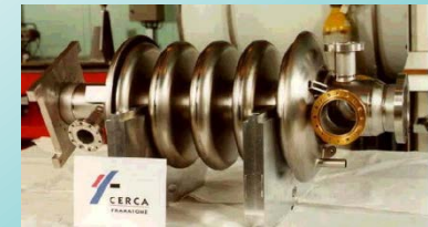
Cavité APT (Los Alamos) 700 MHz - \beta = 0,64
