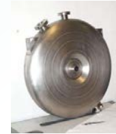
Cavité ré-entrante (Legnaro) 352 MHz - \beta \geq 0,1
