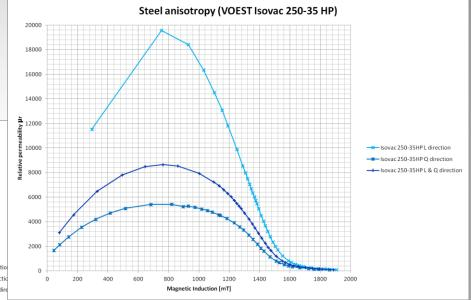
ISOVAC 250-35HP:  $H_c = 30 \text{ A/m}$
