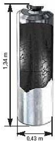
Schéma d'un colis primaire de déchets C vitrifiés R7T7.
