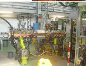
TRASCO @ INFN Legnaro Energy In: 80 keV Energy Out: 5 MeV Frequency 352.2 MHz Proton Current (CW) 30 mA
