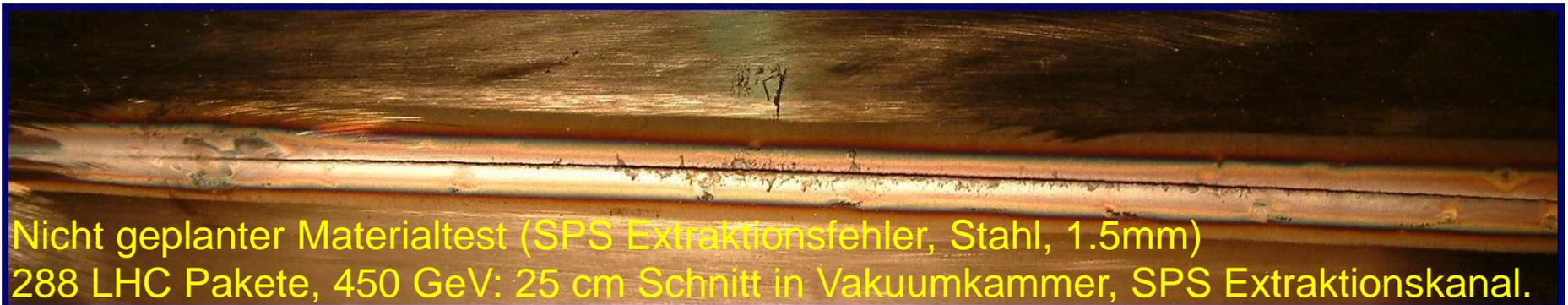
Nicht geplanter Materialtest (SPS Extraktionsfehler, Stahl, 1.5mm)
