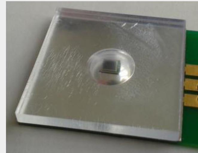
Szintillator-Kachel ( 3 \times 3 \text{ cm}^2 ), SiPMs
