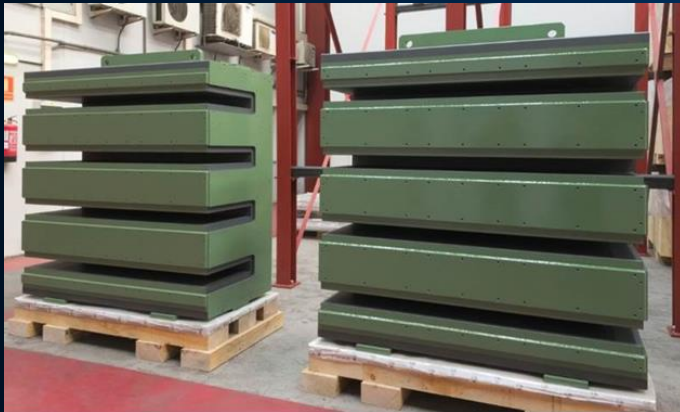
PS Booster magnet bores (NORTEMECANICA S.A)
