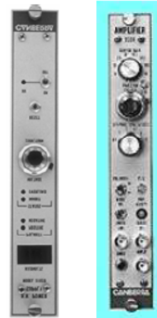
그림. A typical HV Power supply and Amplifier
