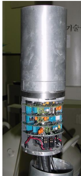
그림. HPGe 검출기의 전치증폭기 실제 사진
