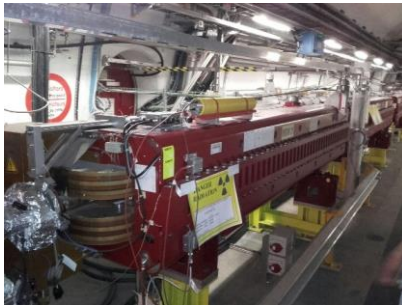
BLM LHC - ~ 3929 мониторов: с3518 ионизационных камер (IC), 108 LIC и 191 SEM
