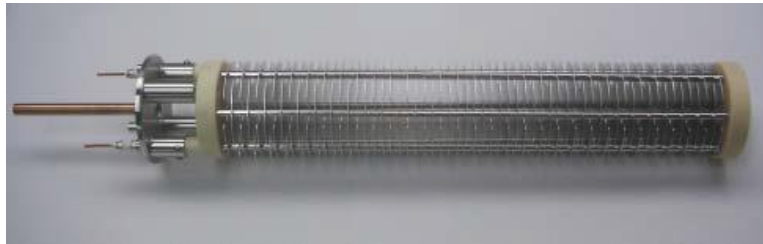
BLM LHC - ~ 3929 мониторов: с3518 ионизационных камер (IC), 108 LIC и 191 SEM
