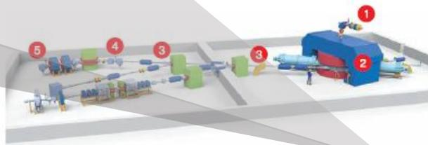
Рис. 64. Экспериментальная установка по синтезу сверхтяжёлых элементов в Лаборатории ядерных реакций в ОИЯИ (г. Дубна, Россия). 1 — инжекционный комплекс (источник  $^{48}\text{Ca}$ ), 2 — циклотрон (циклический ускоритель заряженных частиц), 3 — каналы транспортировки пучка, 4 — мишень (ядра с  $Z = 92, 93, \dots, 98$ ), 5 — детекторная система
