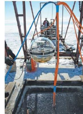
Рис. 105. Спуск новой оптической ячейки на дно озера Байкал
