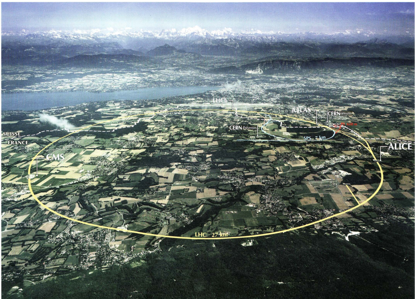
1 Der Large Hadron Collider ist ein 27 km langer, fast kreisförmiger Beschleuniger, der im CERN bei Genf grenzüberschreitend unter schweizerischem und französischem Gelände in einhundert Meter Tiefe fast lichtschnelle Protonen zur Kollision bringt. Große Detektoren ATLAS, ALICE, CMS und LHCb messen die bei jeder Kollision entstehenden Teilchen (© CERN).
