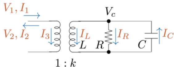
$$\begin{cases} \frac{d|V_c|}{dt} = \frac{1}{2\tau} (|V_0| - |V_c|) - f_0 \delta V_{mp} \frac{eN_e(t)}{2Q_0|V_c|} \omega_0 R_{sh}, \\ \frac{dN_e}{dt} = \alpha(|V_c|) N_e. \end{cases}$$
