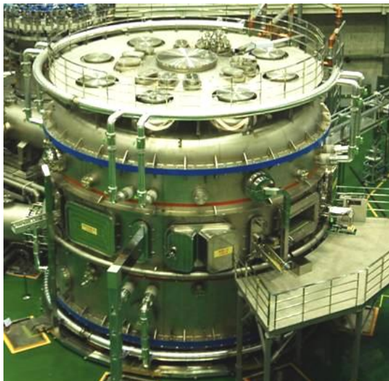
KSTAR: R = 1.8\text{m} , 2\text{MA} , 2008
