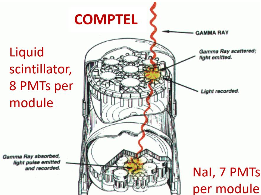
Liquid scintillator, 8 PMTs per module
