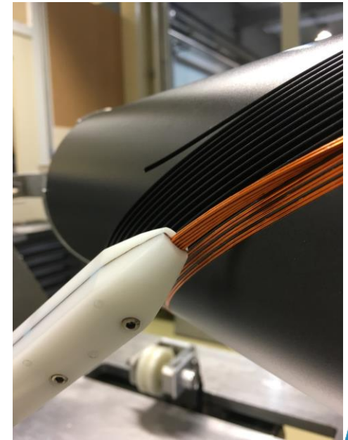
Detail of winding (J. Mazet, et al.)
