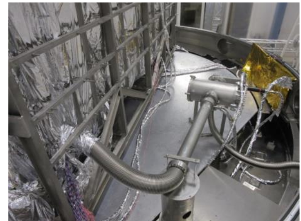
Système pompage/remplissage + burst disks (14 mbars)
