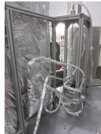
Système pompage/remplissage + burst disks (14 mbars)
