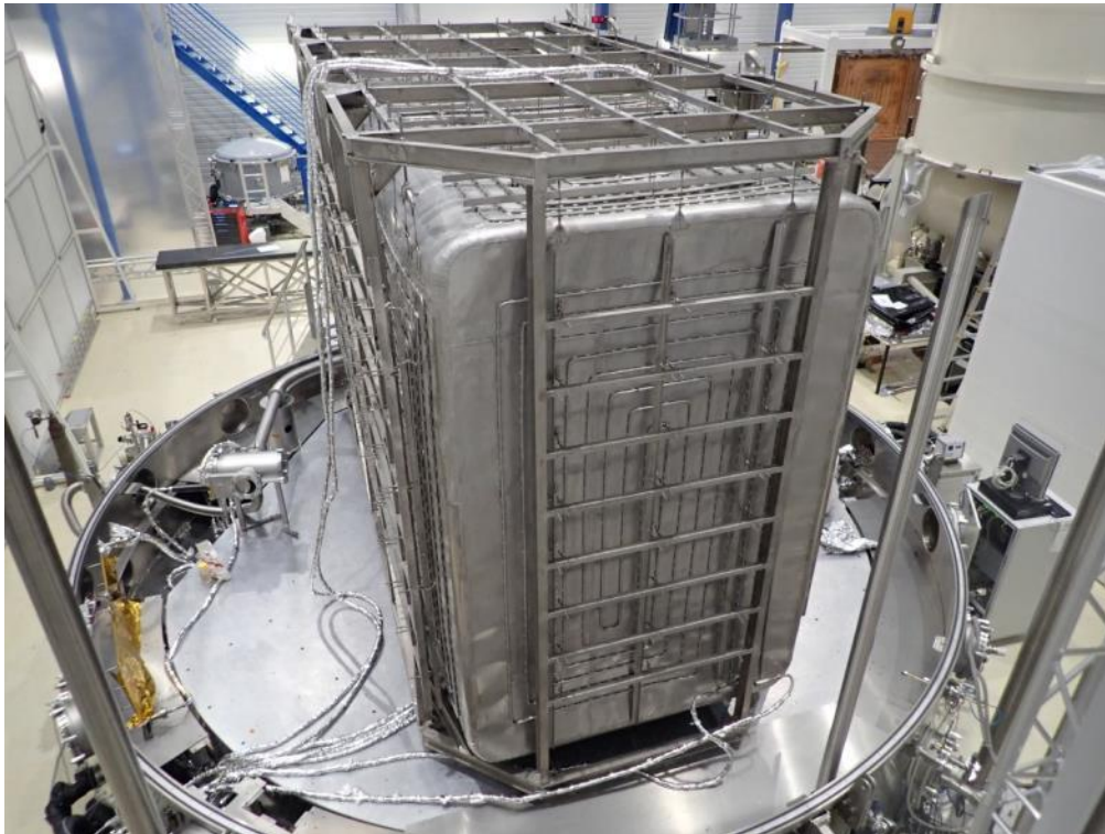
Cuve intérieure (BOX – 6 x 2.5 x 4 m) en inox (1mm d'épaisseur) avec circuit LN2
