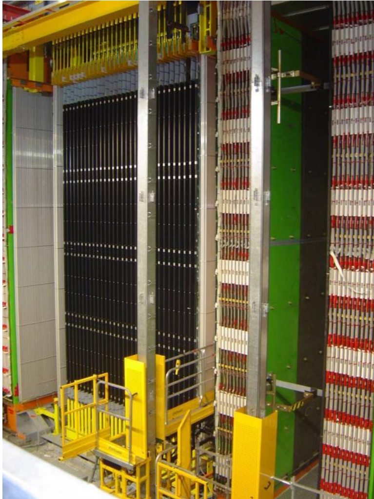
Scintillator planes 5900 m 2 8064 7m long drift tubes
