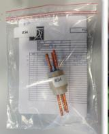
Leak test <1.10<sup>-8</sup>mbar.l.s<sup>-1</sup>
