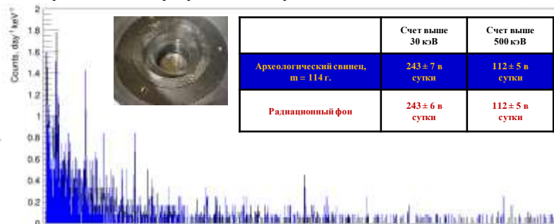
Сравнение энергетических спектров радиационного фона и археологического свинца
