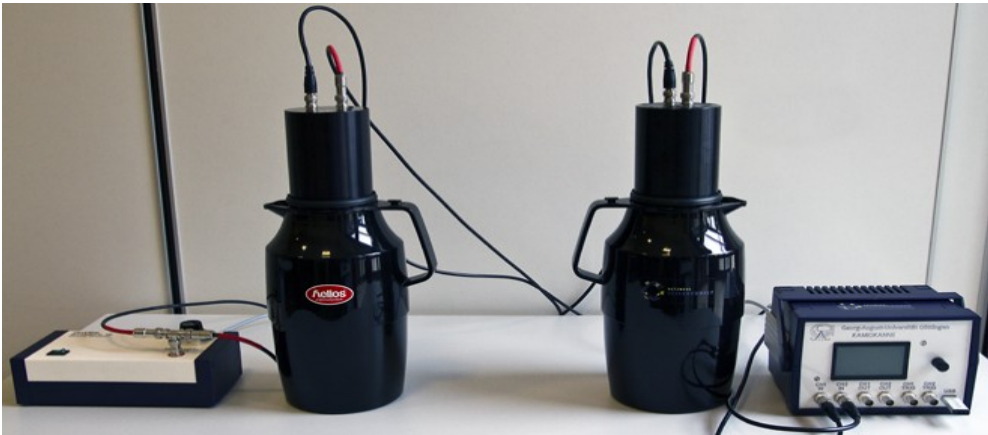
„Kamiokanne“, Netzwerk Teilchenwelt, Gerät von PHYWE
