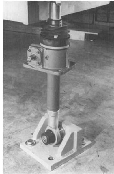
ALS 5-ton machine screw jack strut.
