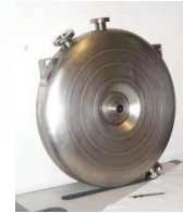
Cavité ré-entrante (Legnaro) 352 MHz - \beta \geq 0,1
