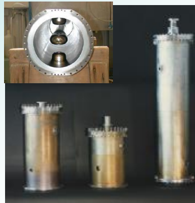
Résonateurs quart d'onde (ALPI, Legnaro) 80 à 352 MHz - \beta = 0,047 à 0,25
