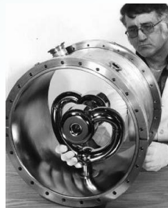
Résonateurs split-ring (ATLAS, Argonne) 97 et 145 MHz - \beta = 0,06 à 0,16
