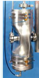
Résonateur demi-onde (Argonne) 355 MHz - \beta = 0,12
