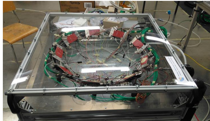
Thermal test using dummy modules
