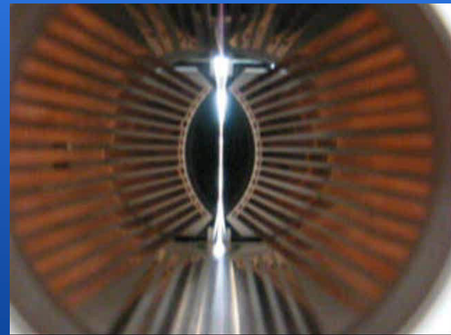
Impact du faisceau sur un collimateur
