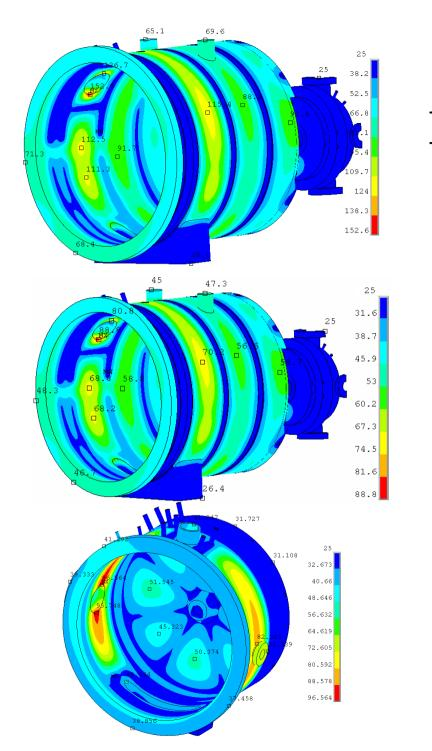
Танк 20, скважность10% (2010 год) Tmax = 152°C
