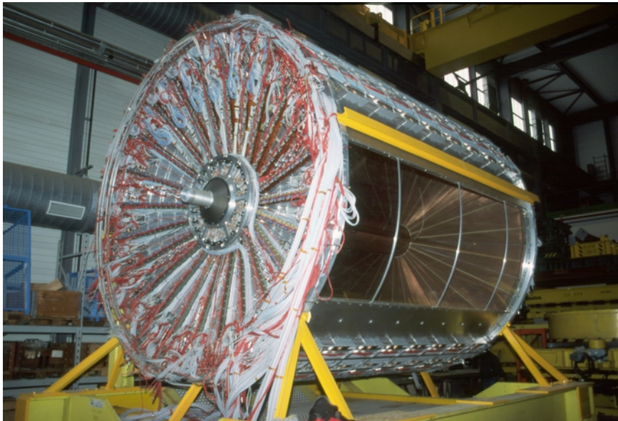
Abbildung 14: Foto der zentralen Spurkammer des OPAL-Detektors nach dessen Abbau im Jahr 2001
