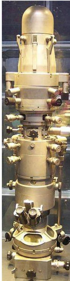
Elektronenmikroskop: 0.1 nm (Millionstel Millimeter)
