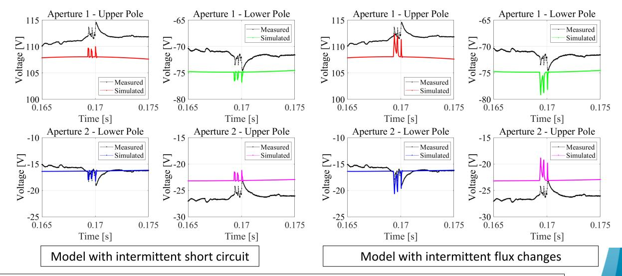
k\_loop=10%, L\_loop=5  $\mu$ H, R\_loop=20 m $\Omega$ -2.4  $\Omega$
