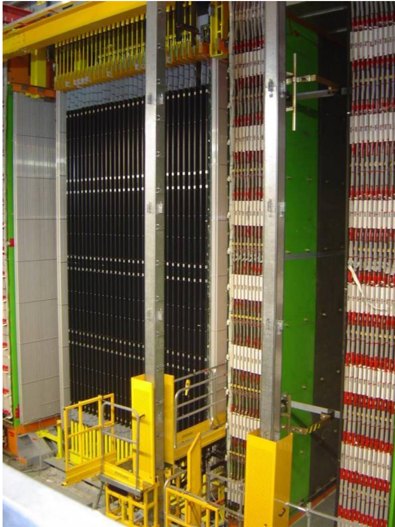
Scintillator planes 5900 m 2 8064 7m long drift tubes
