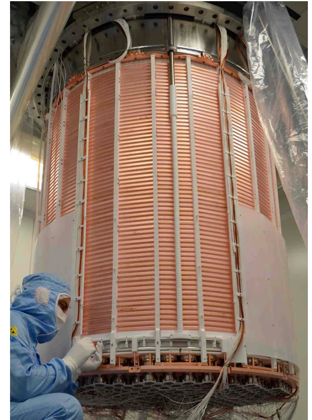
XENONnT at LNGS 5.9 t target LXe
