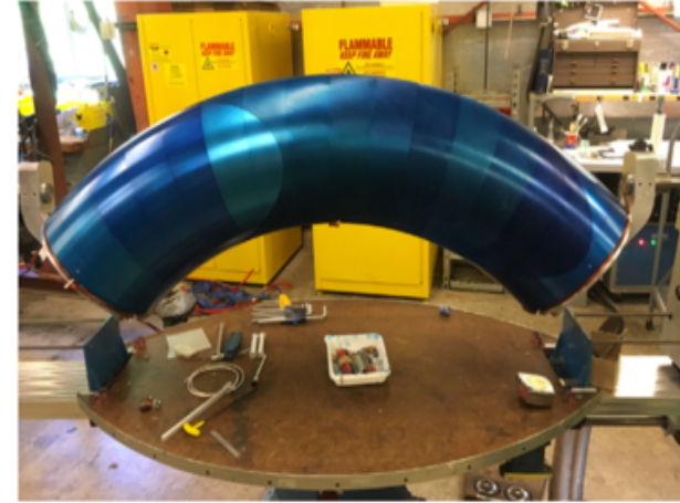
Curved CCT magnet (Berkeley model)
